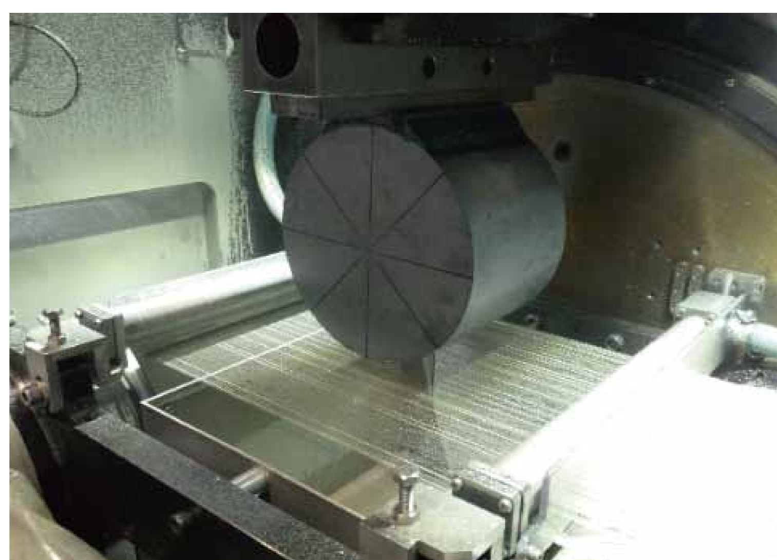
スライシング前のシリコンインゴット マルチワイヤーソー加工機(タカトリ(株)製)
