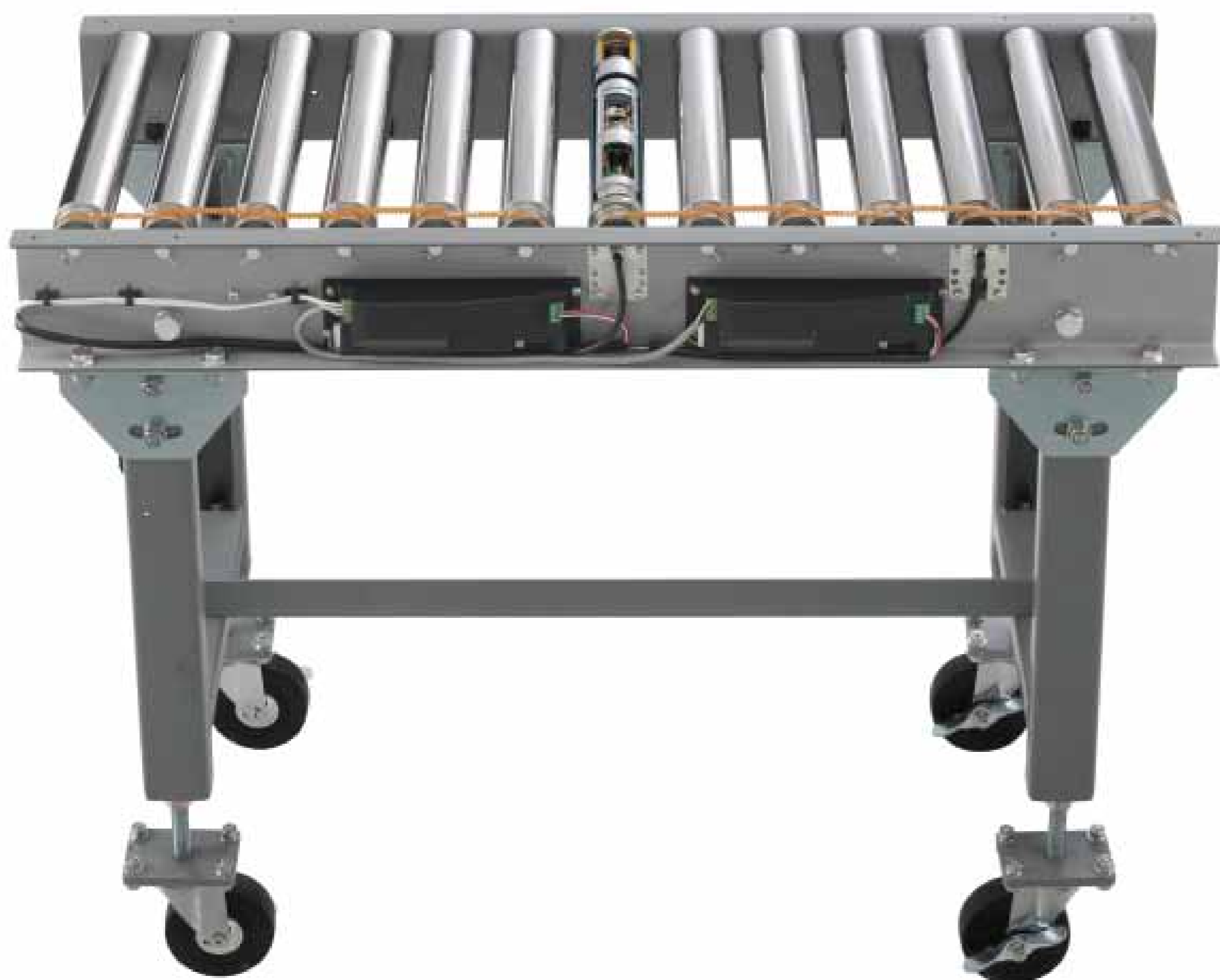
商用電源直結ブラシレスモータローラーを使用したコンベア
