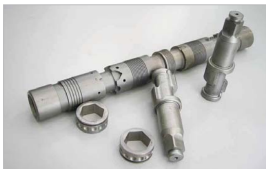
浸炭処理した部品の一例
